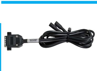
Cableado de emulación, con la función de simulador digital de resistencia variable de unos 100Ω a unos 25.000Ω para la simulación de los sensores (por ejemplo, sensor de temperatura del motor, etc.)
