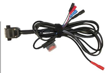
Cableado de emulación/adquisición, con función de generador de energía PWM como PWM POWER con generador de voltaje de 5V integrado; generador de tierra y control de retroalimentación. Se utiliza para la activación de componentes controlados por retroalimentación a través de potenciómetros
