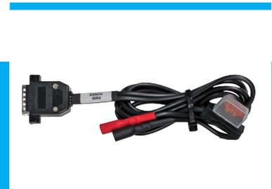
Cableado de emulación, con función de generador de PWM de energía con activación hacia tierra, para el control de cargas electromecánicas inductivas (solenoides, inyectores, etc.). Protección en el positivo de alimentación (+12V batería directa) mediante fusible en línea de 20A
