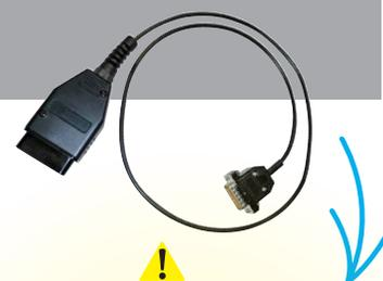
Cuando utilicen el cable EOBBD (**GO2114**), **SPECTRUMpro** NO debe conectarse a ninguna fuente de alimentación: ni a la batería del vehículo, ni a una fuente de alimentación externa, como una batería de banco, etc. Hay que conectar directamente a la toma EOBBD del vehículo y luego continuar con el procedimiento indicado en la pantalla del dispositivo.
